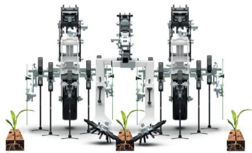
**Maïs IR 75** Disques de protection des plants + binage à doigts
