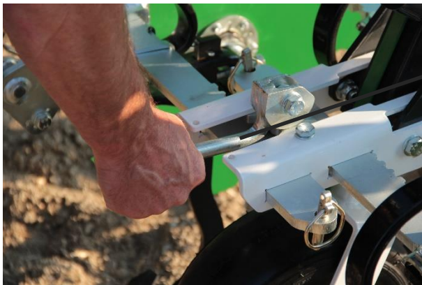
Abbildung 12: Fixierung der Zinkenbalken
