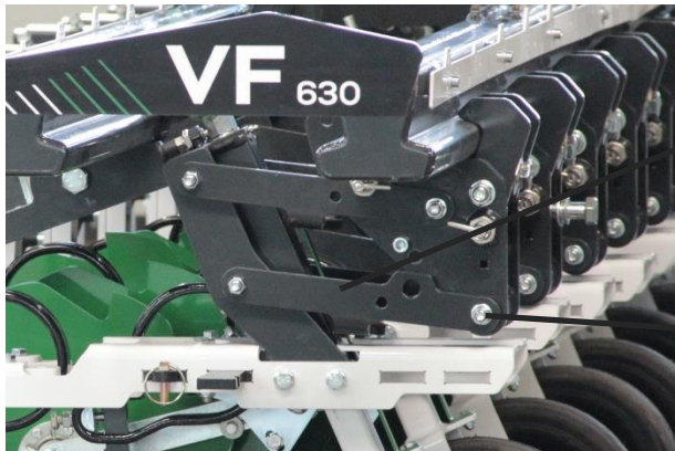
Abbildung 22: Hackmodule am Rahmen
