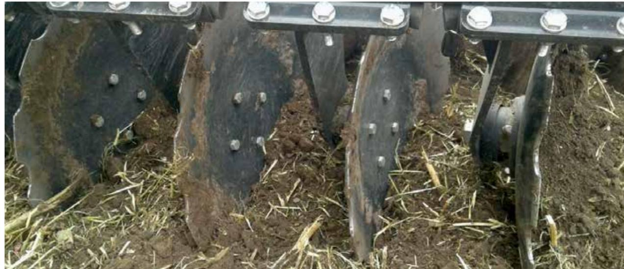
Die spezielle Scheibengeometrie ermöglicht ein verstopfungsfreies Arbeiten bei optimaler Durchmischung im Bereich von 0 cm bis 18 cm.
