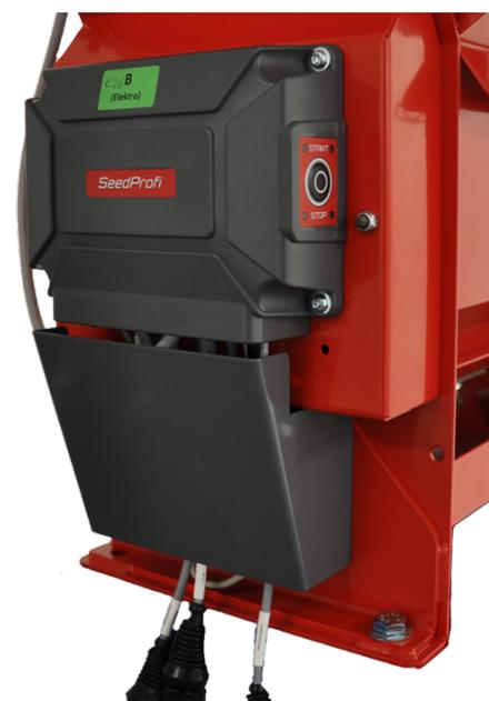
Boîtier de commande avec bouton de calibration
