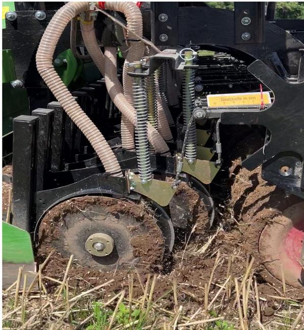
Soc à disques avec tringlerie de pression
