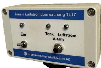
Boîtier pour surveillance du fond de cuve et du flux d'air
