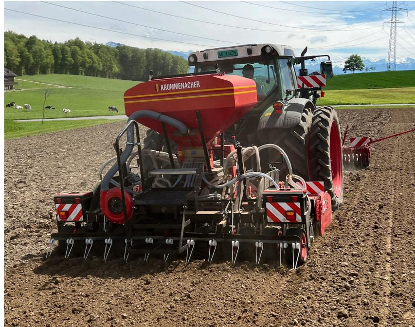
Soc à disques avec trémie de 700 litres
