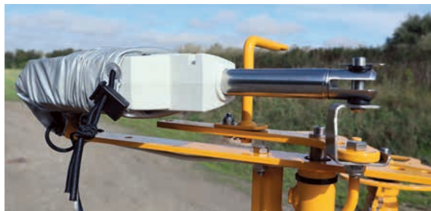
Elektrische Fernsteuerung der Grenzsteuerung für CALIBRATOR TOTZ / ICON
