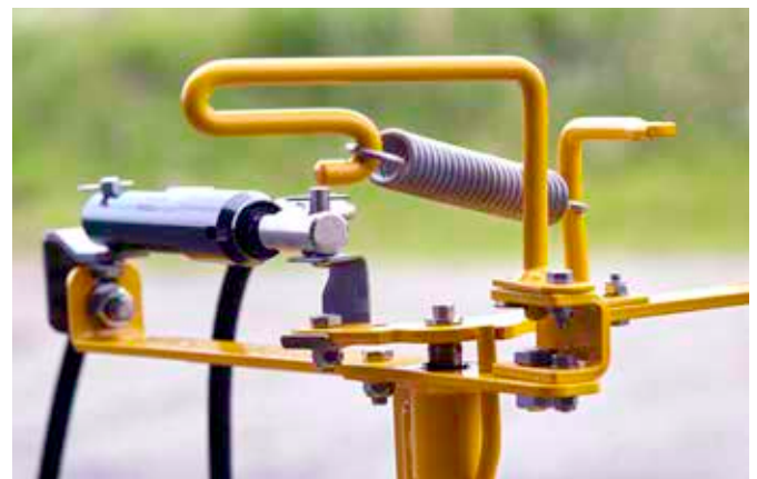
Hydraulische Fernsteuerung der Grenzsteuerung
