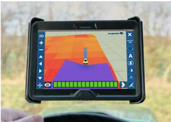
NAVI App zur GPS unterstützten Düngung über ein Android-Tablet (erfordert CALIBRATOR TOTZ).
