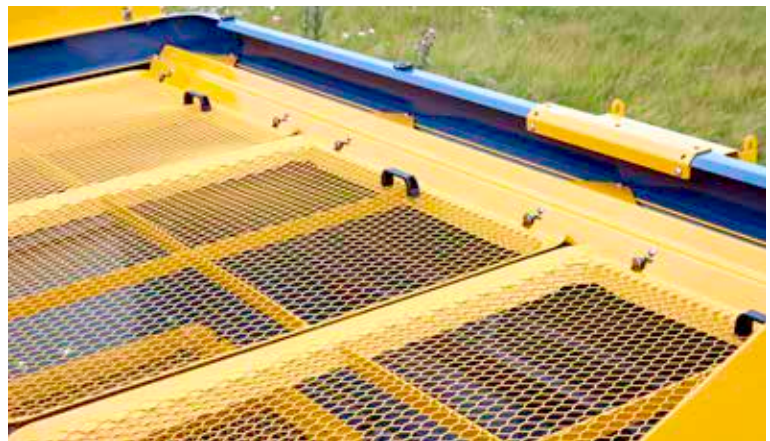
Spezialsiebe, zwischen zwei oberen Modulen
