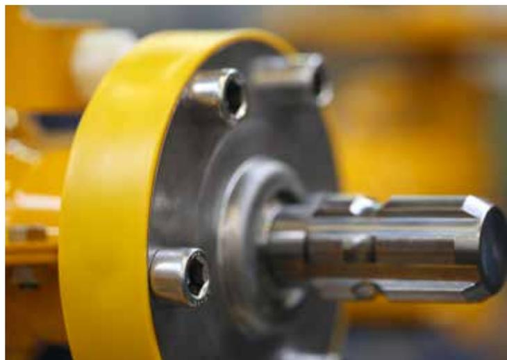
La roue libre imperméable à l'eau et sans entretien protège contre tout dommage le tracteur, le cardan ainsi que la transmission en cas de démarrage de la prise de force à une vitesse de tracteur élevée.
