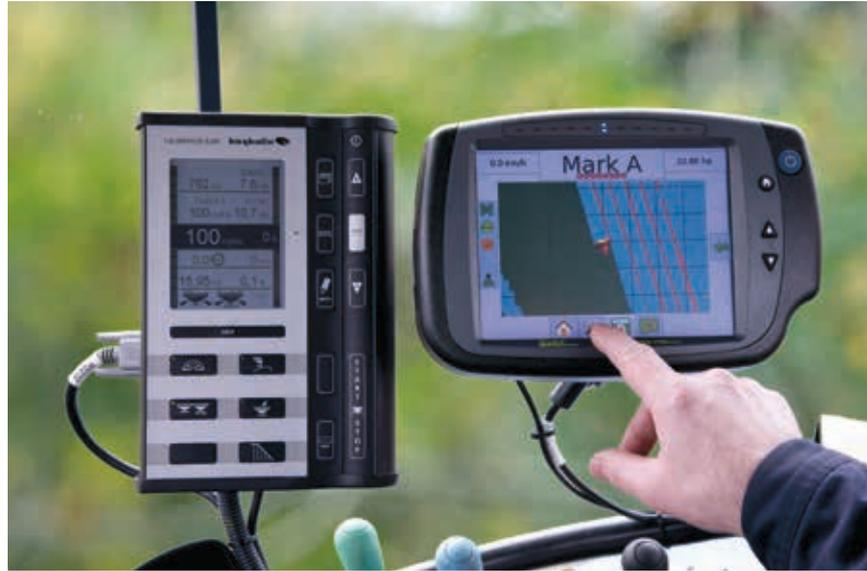
Système GPS TeeJet Matrix connecté à CALIBRATOR ZURF
