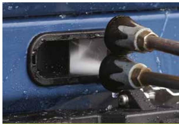
**Derrière les panneaux réflecteurs, les déflecteurs intégrés guident l'eau vers les endroits les plus cachés du châssis ou normalement hors d'atteinte.**
