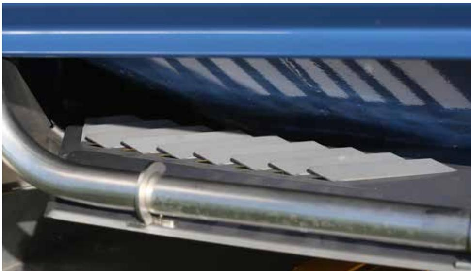
La rotation des disques d'épandage crée un flux d'air qui est aspiré à travers les ailettes du carter de sécurité. Ce qui permet de déposer l'engrais le plus régulièrement possible sur le disque et évite ainsi les effets de rebond qui sont canalisés par le flux d'air.
