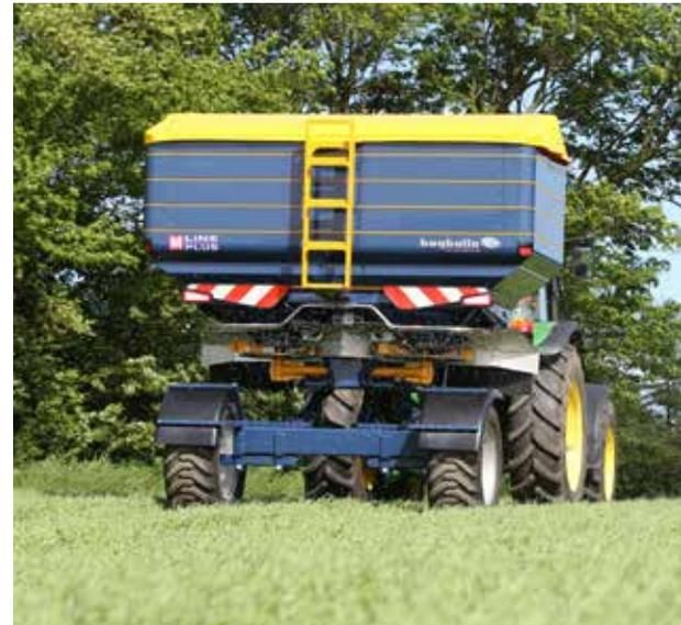
Chariot M45-Trail pour des épandeurs jusqu'à 4500 kg.
