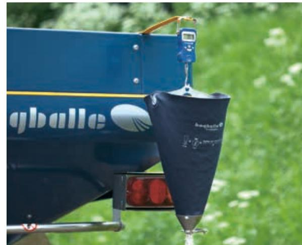
Le S-Indicator avec peson intégré est facile d'utilisation, 2 à 3 minutes suffisent pour effectuer un test de débit complet pour un engrais spécifique. Ce système est à la fois innovant et tellement simple.
