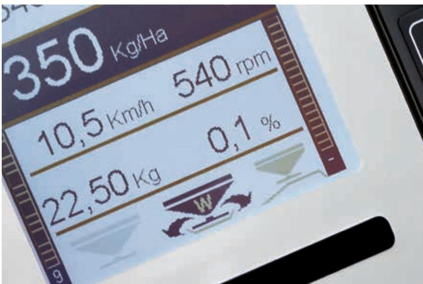
Les épandeurs dotés d'un système de pesée permettent un étalonnage complètement automatique en continu pendant l'épandage, il est donc inutile de procéder à un test de débit manuel.
