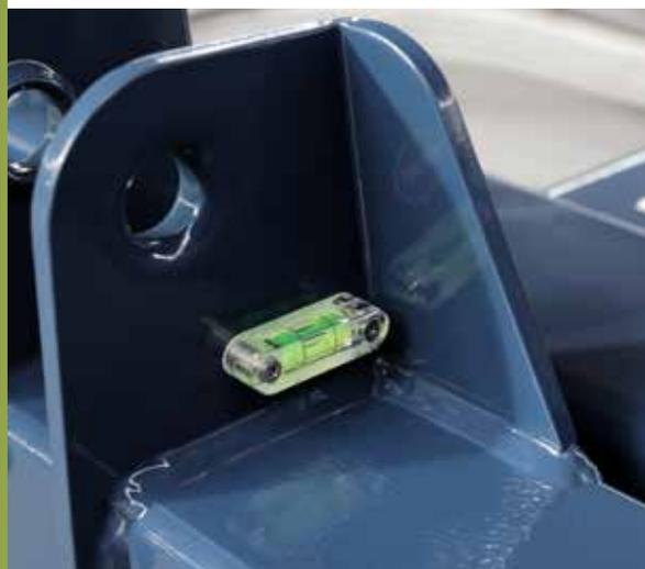
Le niveau à bulle situé sur le troisième point (photo de droite) est fixé parallèlement aux disques d'épandage et constitue le point de référence pour un étalonnage correcte de l'angle d'inclinaison de l'épandeur (photo de gauche).
