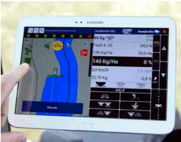
Guidage A-B par GPS en ligne droite ou en courbe est une aide non négligeable dans les parcelles non jalonnées. Les passages sont clairement numérotés et l'écart par rapport au passage suivant est indiqué par la pastille jaune.
