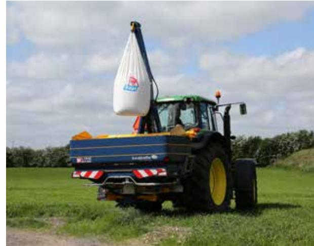
Le modèle BXL 3000 peut soulever jusqu'à 1300 kg et être monté sur des épandeurs jusqu'à 3300 litres.
