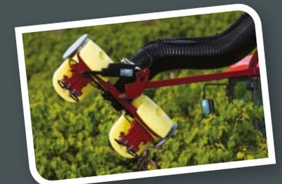
**Diffuseur OPTIMUS avec orientation électrique**
