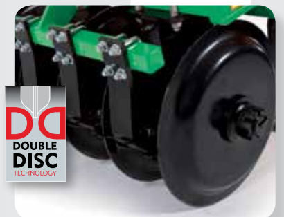
HECK-DD RINGWALZE DD 600 – Die patentierte, vielfach bewährte DD Ringwalze mit 600 mm Durchmesser bietet positive Tiefenkontrolle und sorgt für eine erstklassige, gewellte, wetterbeständige Oberfläche. Die Walze ist mit Hochleistungskratzern ausgestattet.
