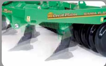
HYDRAULISCHES RÜCKSTELLSYSTEM – Flatliner mit hydraulischer Rückstellung – Die Zinken werden auch mit sehr steinigem Boden und unterschiedlichen Ackerbedingungen fertig. Jede Zinke wird hydraulisch gesteuert, was ein schnelles Auslösen und Rückstellen während der Arbeit ermöglicht. Der Druck für die automatische Rückstellung ist einstellbar. Die Hydraulik ist vollständig mit Druck beaufschlagt, um Wartungs- und Reparaturkosten zu minimieren.
