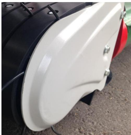
Le réglage s'effectue au niveau de la tôle encart ou des rondelles à l'aide des deux vis arrières.
