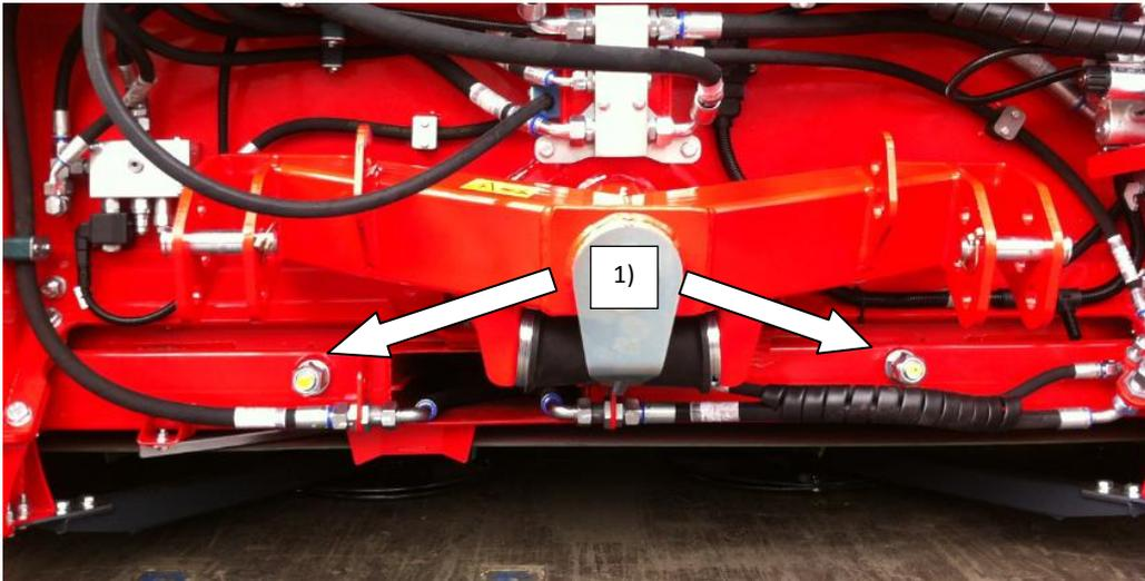
1. Desserrer la fixation centrale du pick-up par le biais du contre-écrou (1) au niveau des tiges filetées
