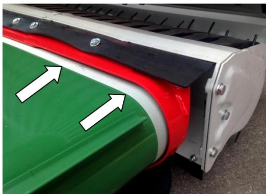
Joint labyrinthe pour convoyeur.
