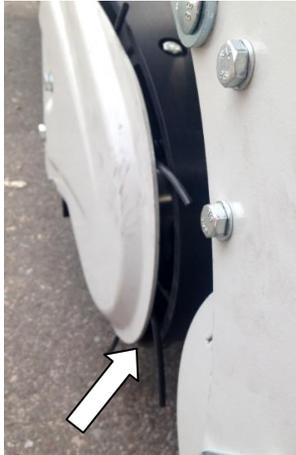
La distance entre le couvercle latéral et le premier racleur doit être d'environ 7-8 mm. La distance avec les dents du pick-up est donc seulement d'environ 2-3 mm.
