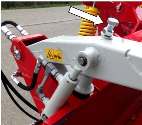
Réglage de la hauteur du rotor (distance entre le rotor et le pick-up)
