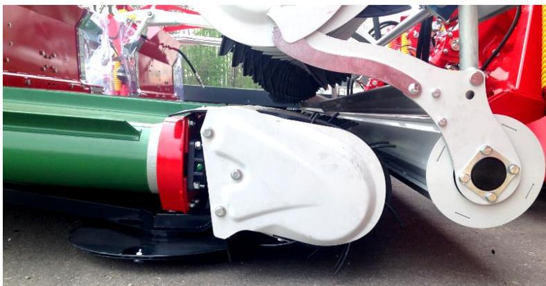
Choisir la bonne longueur du bras haut afin que les dents du pick-up atteignent la hauteur de travail souhaitée par rapport au sol. Sur un sol plat, la distance entre les dents et le sol doit être d'environ 1-2 cm.
