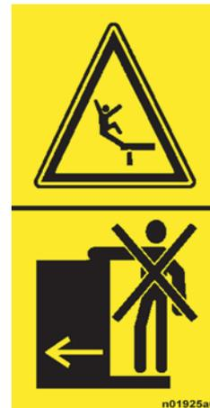
**Gefahr, unter die Maschine oder deren Bauteile zu geraten (4)**
