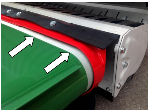
Labyrinthdichtung für Förderband.
