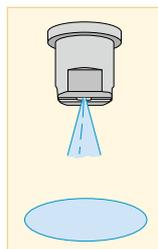
Elle produit une empreinte elliptique avec un angle de 25°. Cet angle de jet étroit produit un fort impact qui convient bien au nettoyage ou au traitement des arbres et arbustes qui nécessitent une longue portée.
