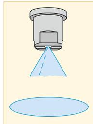
Elle produit une empreinte elliptique avec un angle de 65°. La distribution obtenue est uniforme avec un recouvrement correct des empreintes des buses voisines.
