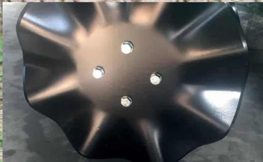
Die Scheiben haben einen Durchmesser von 400 mm und einen Abstand von 150 mm. Das Wellprofil begünstigt den Antrieb der Scheibe, und sorgt gleichzeitig für eine gute Krümmelung des Bodens.
