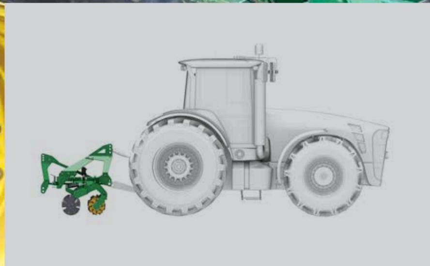
Der X-Cut Solo kann als Frontanbaugerät, oder alternativ als Heckanbaugerät gefahren werden. Je nach Kundenwunsch kann der Anbaubock für Frontanbau oder für Heckanbau verbaut werden. Es lassen sich aber auch beide Anbauböcke gemeinsam montieren.
