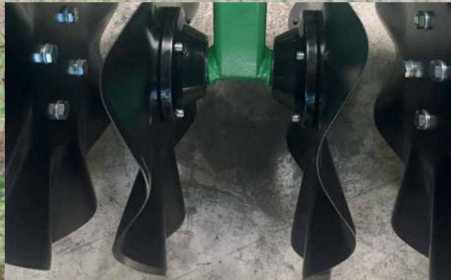
Die Schneidscheibe liegt beim X-Cut auf der zweiten Welle der beiden Arbeitswerkzeuge. Die Scheiben sind einzeln gelagert. Durch die Einzel-lagerung und der damit verbundenen unterschiedlichen Geschwindigkeit der Einzelscheiben, wird eine Selbst-reinigung der Scheiben bewirkt.
