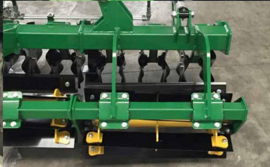
Der Kerner X-Cut Solo verfügt über eine Konturanpassung. Messer und Schneidscheiben sind in kurzen Einzelabschnitten gelagert. Die Arbeitselemente passen sich so der Bodenkontur an.
