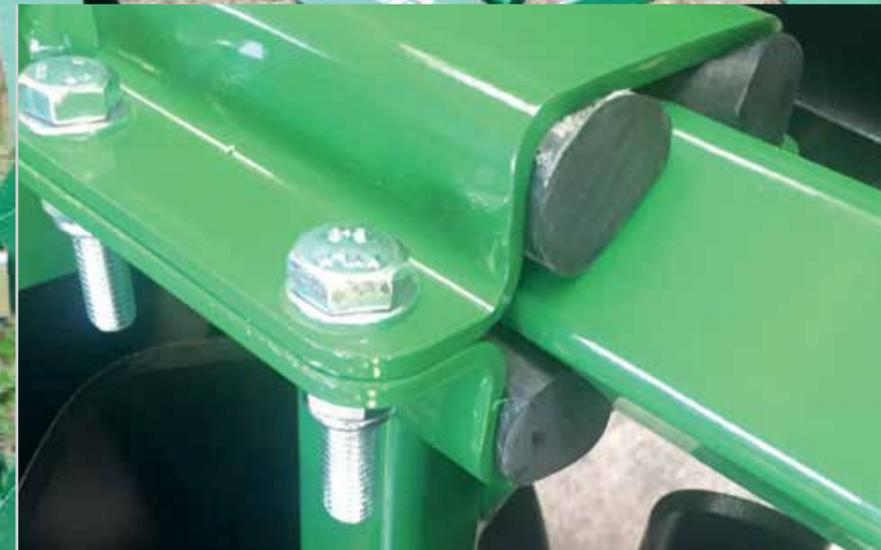
Der Kerner X-Cut verfügt über eine doppelte Steinsicherung. Neben der Messerwalze ist auch die Schneidscheibenreihe gegen Steinbesatz geschützt. Beide Reihen verfügen über eine 4 Kammer-Taschenlagerung.
