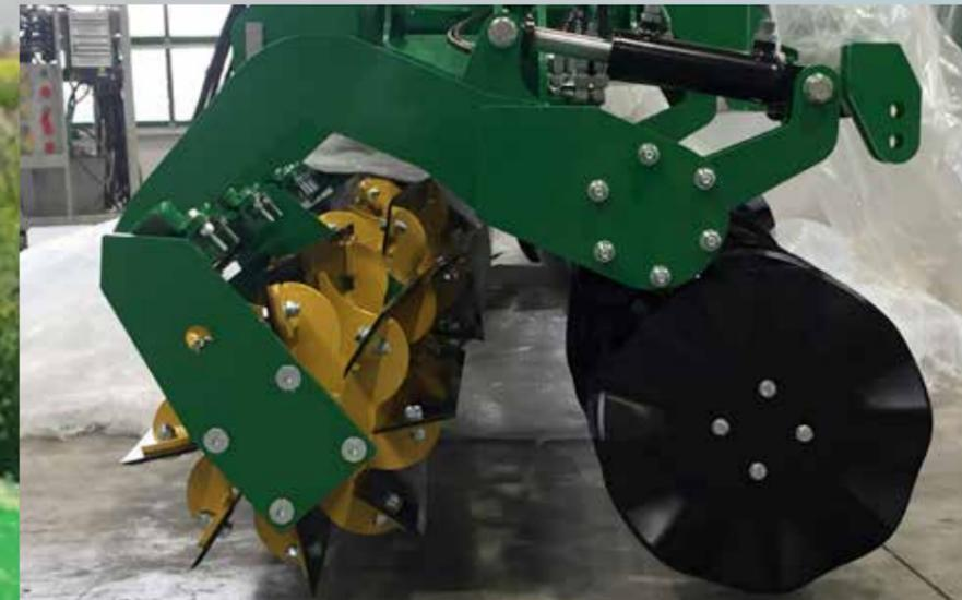
Durch einen Arbeitszylinder kann der Schneiddruck von der hinteren Schneidreihe auf die vordere Messerreihe verstellt werden. So kann die Schnittintensität ideal den Arbeitsanforderungen angepasst werden.
