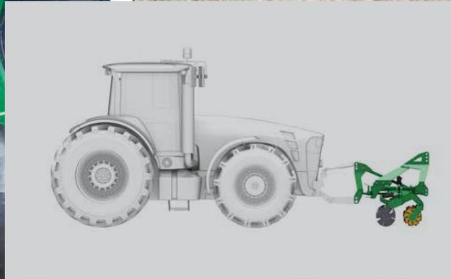
Der Kerner X-Cut Solo wird über einen Anbaubock mit der Dreipunkt-Unterlenkeranhangung des Schleppers verbunden.
