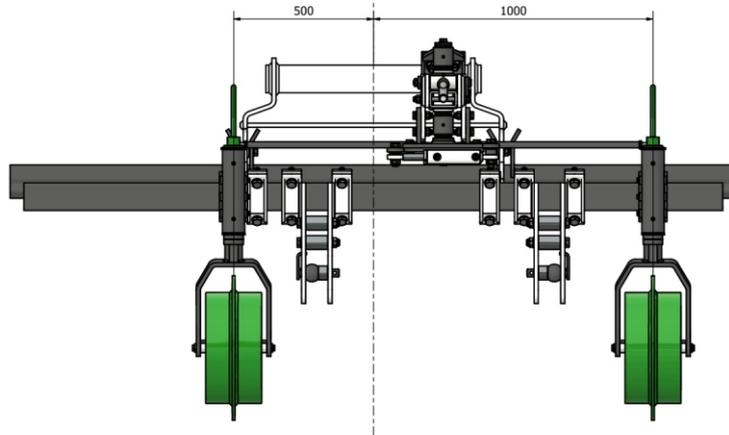
Montage sur une poutre permettant le décalage latéral de 25 cm. Cette solution permet de sarcler en 6 x 50 et 4 x 75 cm avec une voir de 150 cm
