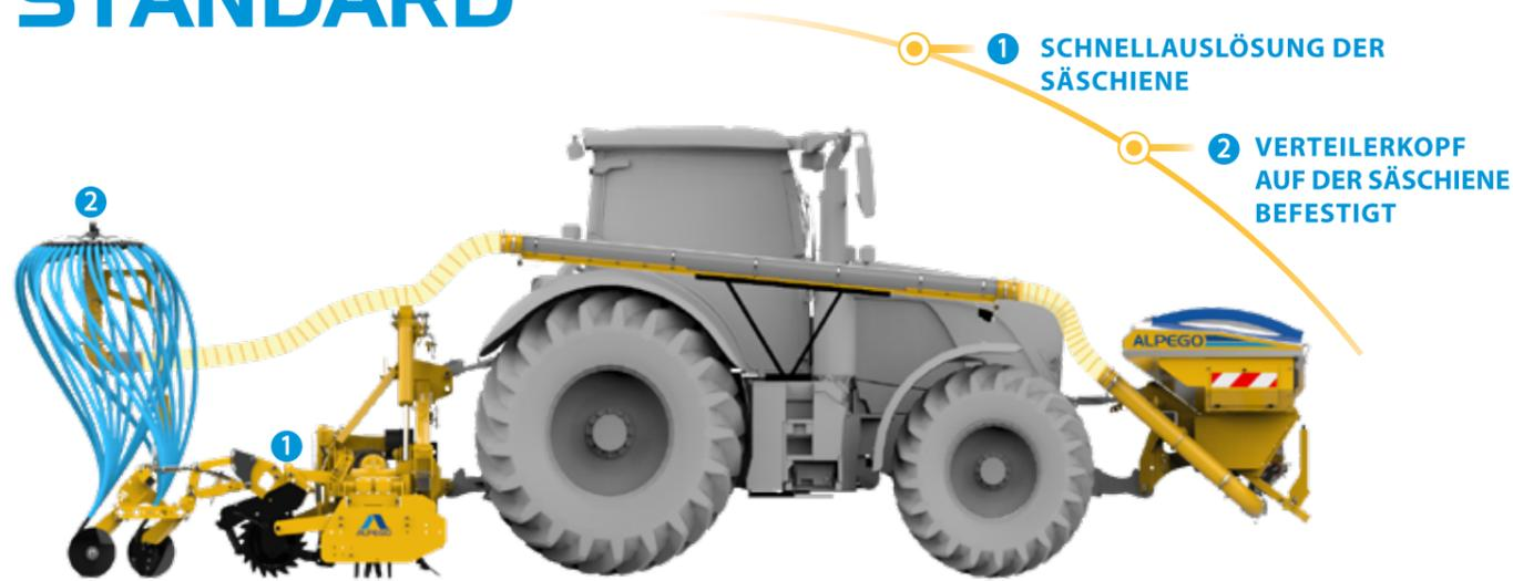
Die Standard Ausführung hat den Fronttank, die Säschiene und den **zentralisierten Verteilerkopf auf der Säschiene** befestigt und mit der Fahrgassenschaltung ausgerüstet. Die Breite während des Transports auf der Straße beträgt 2,5 m.
