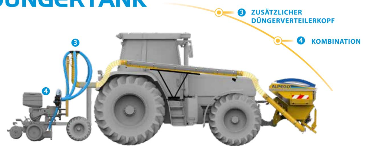
Die Düngung-Ausführung, mit dem spezifischen Verteilerkopf, hat den Fronttank in Kombination mit verschiedenen Geräten: Hackmaschinen, Einzelkornmaschinen, Grubber, Kurzscheibeneggen, Walzen, usw.
