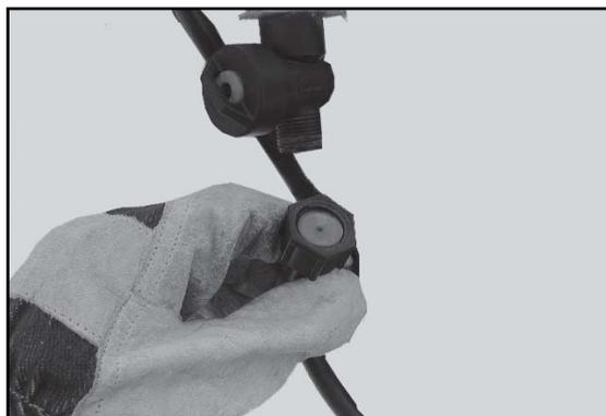
Le rôle de ces pastilles est de calibrer le débit nécessaire. La gamme de pression est de 0 à 4 bar.
