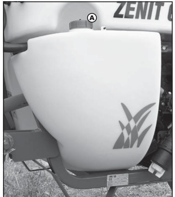
Pour utiliser la cuve de rinçage, tournez la vanne d'aspiration MANIFOLD, située au dessus du filtre d'aspiration, sur le pictogramme "cuve de rinçage".
