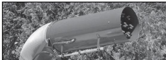
Le modèle M est en acier et se monte sur une turbine double. Il dispose d'une sortie avec 10 buses et de deux sorties avec 3 buses chacune. Les deux sorties supérieure et inférieure sont orientables.
