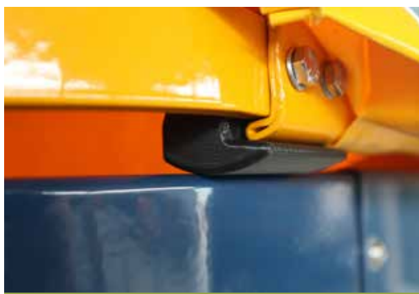
Nouveaux patins élastomère pour la protection de la peinture. Le patin est monté directement sur le cadre de la bâche.
