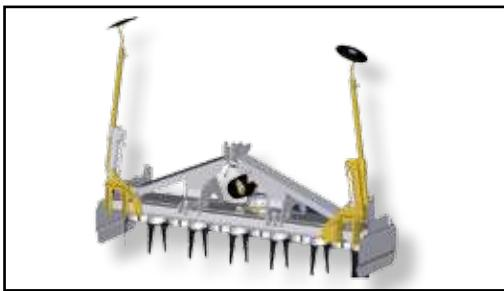
**Il disco segnafila**, è un dispositivo che traccia una linea di riferimento sul terreno per agevolare le operazioni di semina.
