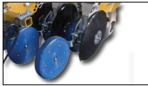
**Ruotino in gomma per il controllo della profondità**, è un dispositivo che permette di impostare la profondità di semina per ogni singolo disco di semina.
