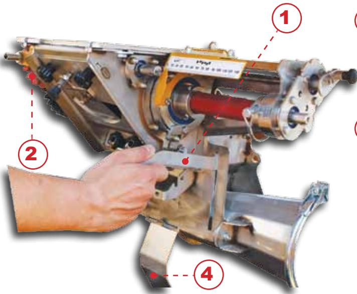
**1 Prova di semina facilitata**, recupero facile del prodotto durante la prova di semina grazie al sistema con sportello basculante.
