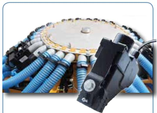
**Le nuove valvole di chiusura tram-line** permettono di utilizzare tutti i cicli previsti dai più diffusi sistemi di diserbo e polverizzazione. La centralina applica una riduzione precisa della distribuzione di prodotto in corrispondenza delle file chiuse.
