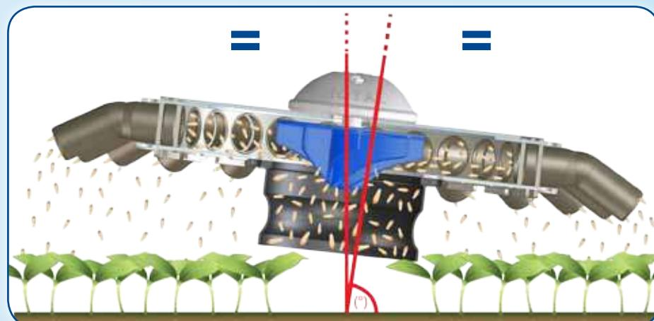
La soluzione Alpego ROTAL garantisce una miglior distribuzione del prodotto su ciascuna fila, il movimento rotativo dell'elica sparge il seme in maniera uniforme su tutte le uscite della testa di distribuzione, anche nel caso lavori in maniera non orizzontale. È provata una migliore nascita e miglior rendimento della semina.
