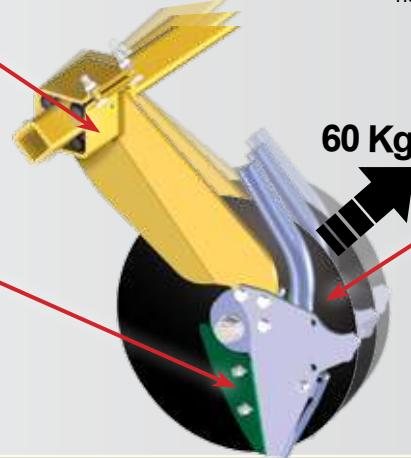
**Disco di semina**: il disco di diametro 355 mm, opportunamente inclinato con profilo tagliente permette una perfetta e costante penetrazione e motricità in tutte le situazioni.
