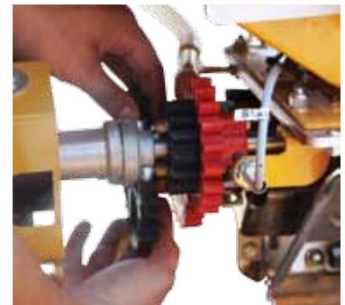
**2 Cambio di velocità ad ingranaggi**
