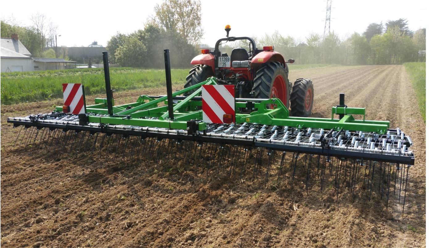
La herse étrille ETR GA RD est composée de panneaux 1,56m multiples. Chaque panneau est composé de 6 barres porte dents souples (pas de 2,5cm; 60 dents pour 1,56m. Chaque dent est articulée sur un axe bagué et tendu par un ressort. La tension des ressorts est réglable par une vis sans fin sur chaque panneau. Ce montage assure une pression constante quelque soit les irrégularités du sol et permet une grande précision de travail sur cultures à des stades sensibles.
