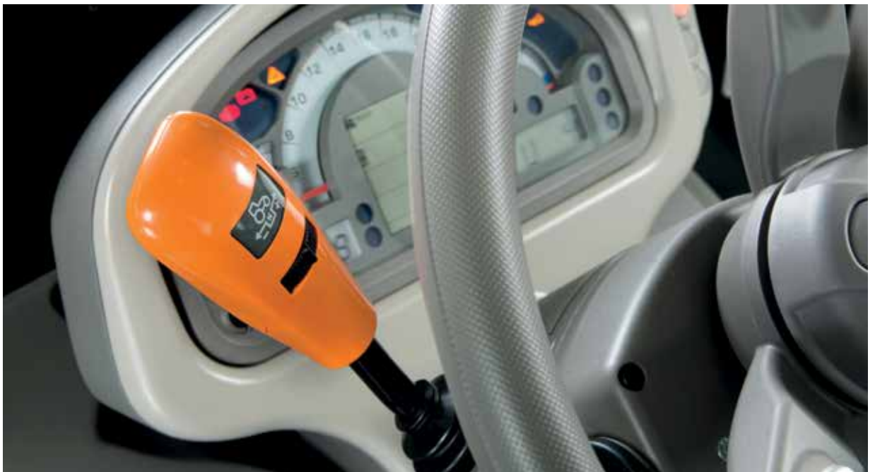
Der Hebel des hydraulischen Wendegetriebes verfügt über ein praktisches Bedienelement zur Regelung des Ansprechverhaltens beim Richtungswechsel. Durch Betätigung des Einstellrads kann das Ansprechverhalten in 5 verschiedenen Stufen moduliert werden.
