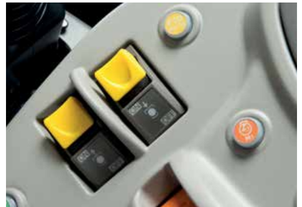
Tasten für elektrohydraulisch zuschaltbare Zapfwelle.
