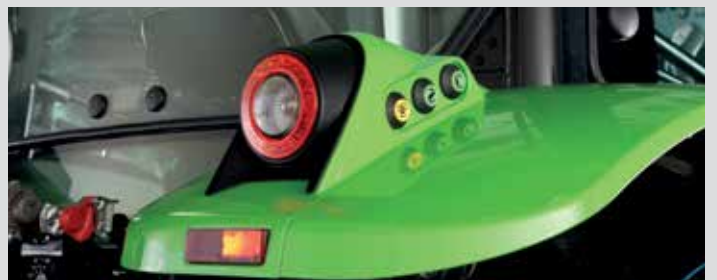
Kraftheber- und Zapfwellen-Bedientasten auf Kotflügeln.
