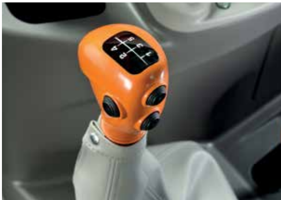
Schalthebel mit Powershift-Tasten und Taste der elektrohydraulischen ComfortClutch-Kupplung.
