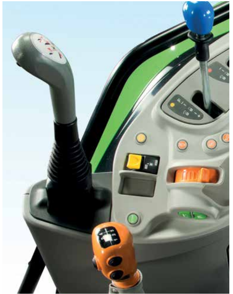
In der rechten Konsole perfekt integrierter Joystick für die Betätigung des Frontladers.
