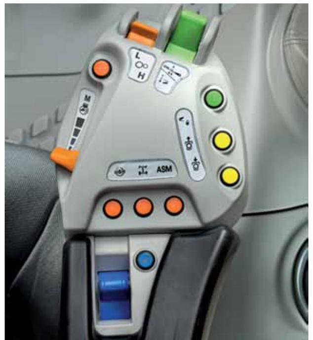
Accoudoir multifonction de série avec commande du relevage arrière simplifiée et distributeur dédié pour le relevage avant.
