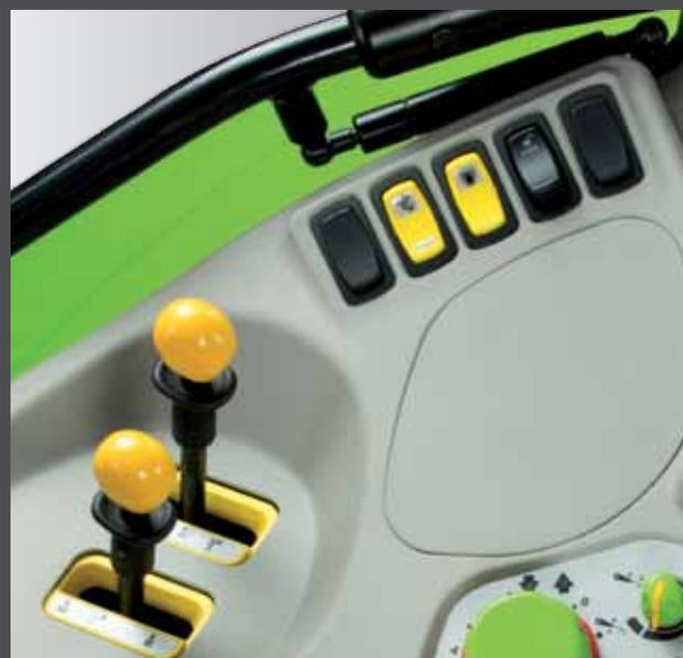
Levier de sélection du régime PDF avec activation et désactivation par le biais de pratiques commandes électrohydrauliques.
