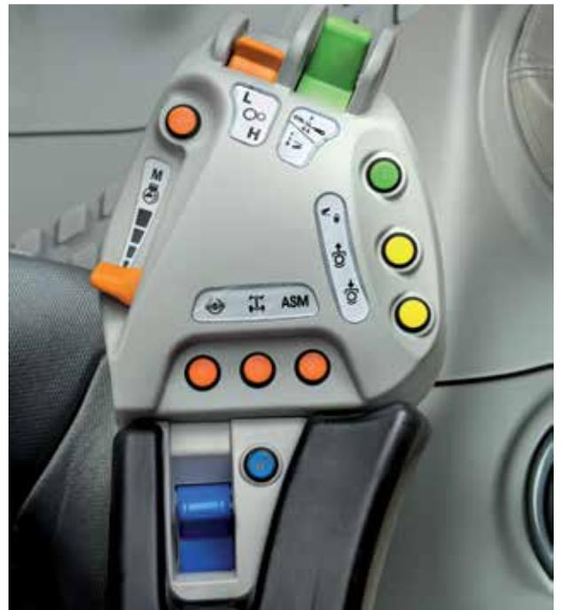
Serienmäßige Seitenkonsole mit vereinfachten Bedienelementen für den Heckkraftheber und Hebel/Steuerventil für den Frontkraftheber.
