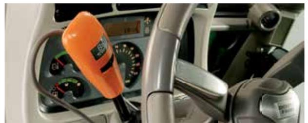
Powershuttle mit SenseClutch: 5-stufiges Ansprechverhalten, auch während der Fahrt.
