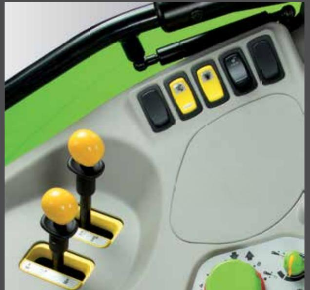
Hebel zur Auswahl der Zapfwellendrehzahl mit Zu- und Abschaltung durch praktische, elektrohydraulische Bedienelemente.
