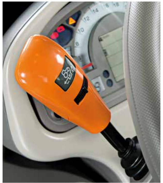
elektrohydraulische Wendeschaltung (Powershuttle), in 5 Stufen einstellbar, in den GS Varianten.
