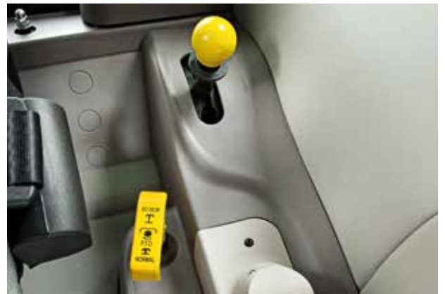
Vorwahl Zapfwellen-Geschwindigkeiten und Umschaltung auf ECO-Zapfwelle.
