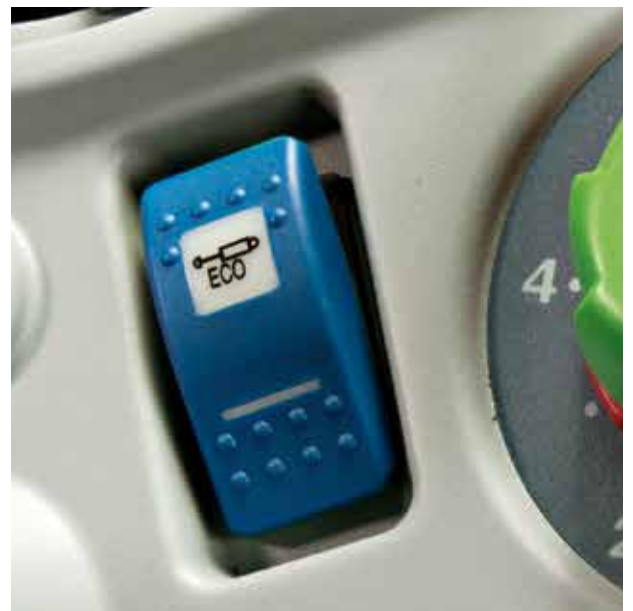
Aktivierungstaste 60l ECO Hydrauliksystem.
