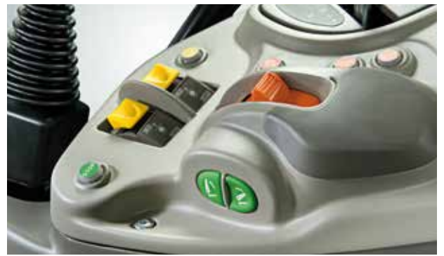
Neue Tasten für die Schnell-Ansteuerung des Krafthebers.
