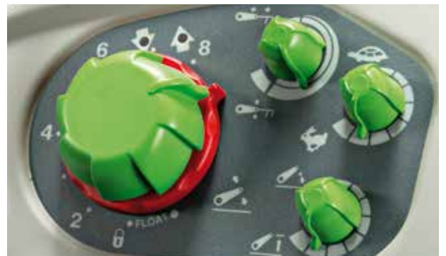
Schalttafel für die Einstellung des Heckkrafthebers.
