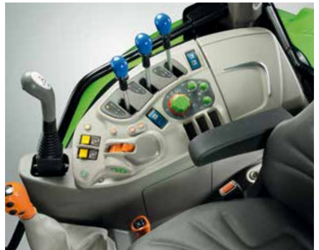
Seitenkonsole mit Joystick für den Frontlader.
