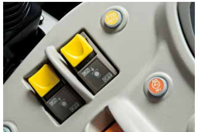
Tasten zur Aktivierung von Front- und Heckzapfwelle.
