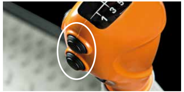
Tasten zum Schalten der Lastschaltstufen.
