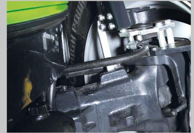
Vorderachse. Maximaler Federeffekt und ein Lenkeinschlagswinkel von bis zu 50 Grad.
