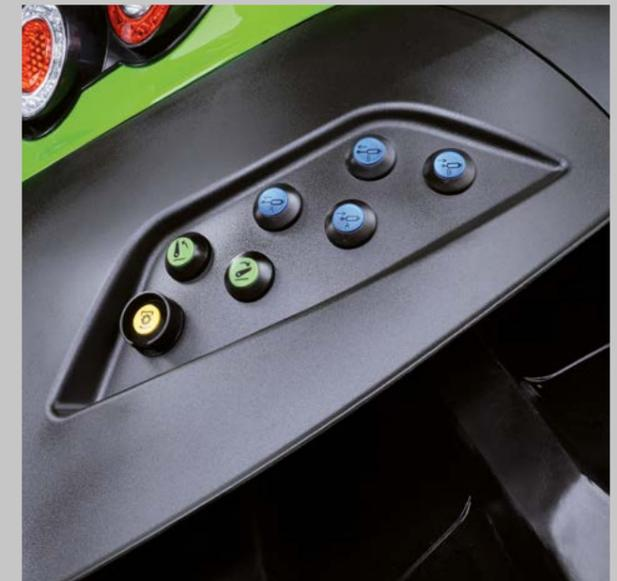
Externe Steuerung der Hydraulik- und Zapfwellenfunktionen von beiden Seiten möglich.
