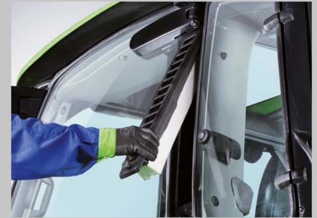
Der Kabinenluftfilter in der Kabinensäule ist einfach und werkzeuglos zugänglich.
