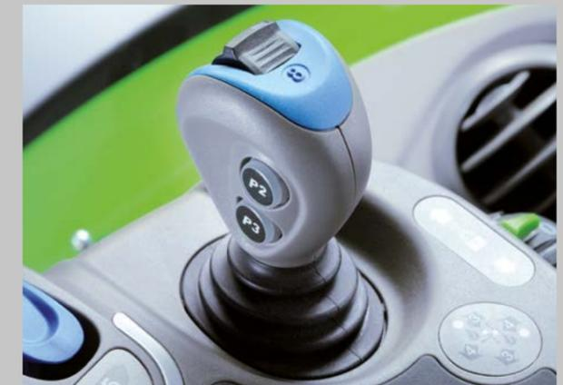
Über den Kreuzsteuerhebel mit Wippschalter lassen sich drei hydraulische Steuergeräte bedienen.
