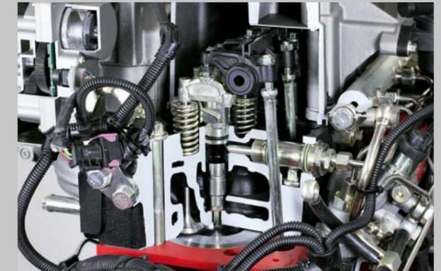
DCR Technologie. 2.000 bar Einspritzdruck garantiert maximale Motoreffizienz.
