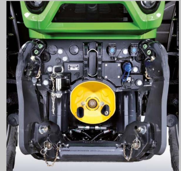
Integrierter Frontkraftheber mit einzigartig kurzer Distanz zur Frontachse. Geringer Überhang. Beste Traktor-Balance.
