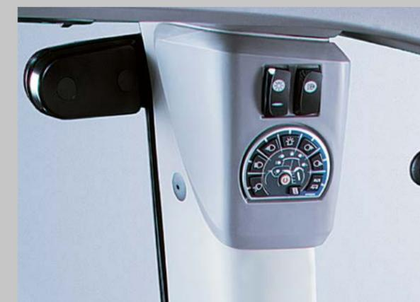
Fahrlicht, Arbeitslicht und Kabinenlicht in einem Bedienpanel zusammengefasst.
