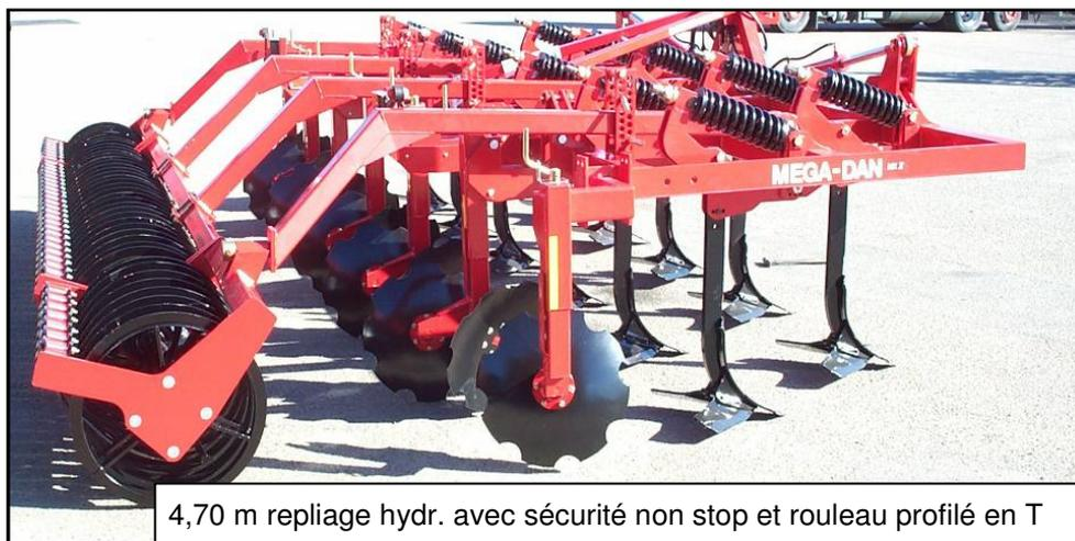
4,70 m repliage hydr. avec sécurité non stop et rouleau profilé en T
