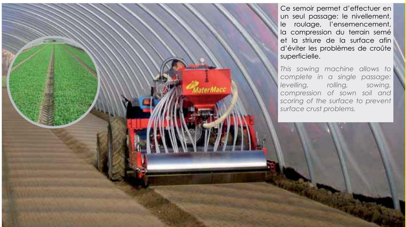
Ce semoir permet d'effectuer en un seul passage: le nivellement, le roulage, l'ensemencement, la compression du terrain semé et la striure de la surface afin d'éviter les problèmes de croûte superficielle.
