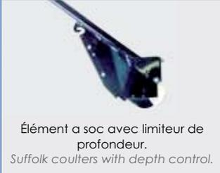
Élément à soc avec limiteur de profondeur.
