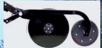
Élément à double disques équipé avec roulette plumbeuse.
