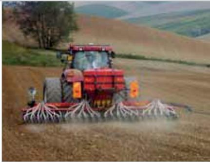
Semoir pneumatique en ligne pour le semis sur terrain travaillé ou semi-travaillé. Dans la version MSD, les châssis se replient par un système hydraulique pour obtenir une largeur de transport égale à 2,55 mètres.
