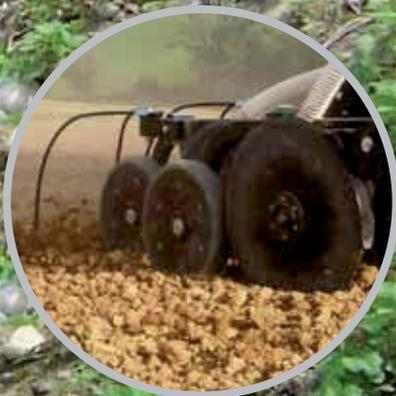
Détail de l'élément à double disque du semoir pour céréales MSD-60.
