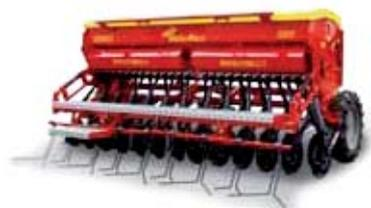
Semoir mécanique en ligne pour céréales, colza, soja, luzerne et autres fourragers sur des terrains exploités. Semoir compact, maniable, disponible avec des largeurs de travail allant de 2,5 m à 4 m. Modèle largeur de 6 mètres GRANO-600.
