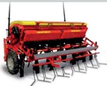
Semoir mécanique en ligne pour céréales, colza, soja, luzerne et autres fourragers sur des terrains exploités. Semoir compact, maniable, disponible avec des largeurs de travail allant de 2,5 m à 4 m.
