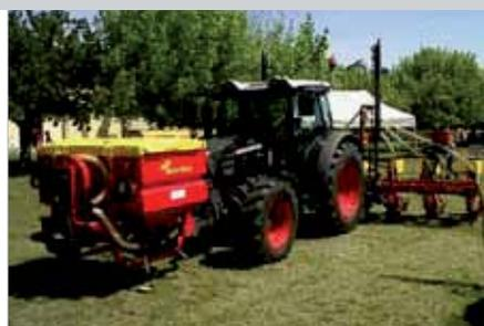
Dispositif avant pour distribuer des engrais granulaires apte aux semoirs et aux bineuses. Porté sur les 3 points avant d'un tracteur, le réservoir a une capacité de 1.200 litres pour permettre une bonne autonomie entre un chargement et l'autre. La distribution est confiée à deux doseurs volumétriques actionnés par un moteur électrique de 12 volts.
