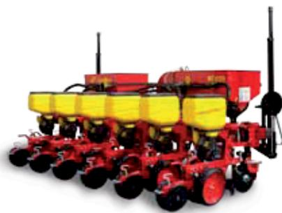
Semoir idéal pour faciliter la modification de l'écartement entre rangs grâce au Système Easy-Set (brevet MaterMacc) monté sur le châssis principale. Ce système permet de faire coulisser les éléments semeurs sur une poutre spéciale montée en parallèle par rapport au châssis.
