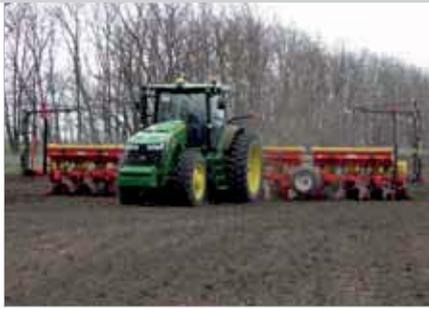
Il répond aux exigences des grandes exploitations agricoles. Le triple châssis fixe garantit la robustesse et est disponible de 16 à 24 rangs selon les exigences de l'opérateur. Le chariot de transport intégré permet de le déplacer facilement tout en bénéficiant d'un encombrement minimum.
