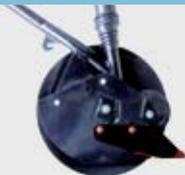
Élément à disques équipé de limiteur de profondeur.
