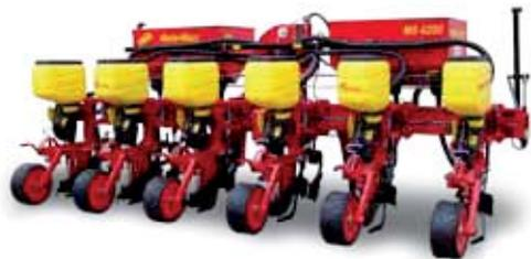
Semoir idéal pour faciliter la modification de l'écartement entre rangs grâce au Système Easy-Set (brevet MaterMacc) monté sur le châssis principale. Ce système permet de faire coulisser les éléments semeurs sur une poutre spéciale montée en parallèle par rapport au châssis.
