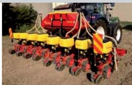
Le sigle PRO identifie un semoir qui unit, aux qualités déjà décrites pour le MS 8230, est doté d'une trémie pour l'engrais de 1200 litres, avec un réglage centralisé du débit et avec un système de distribution pneumatique sur chaque rang à n'importe quel écartement.
