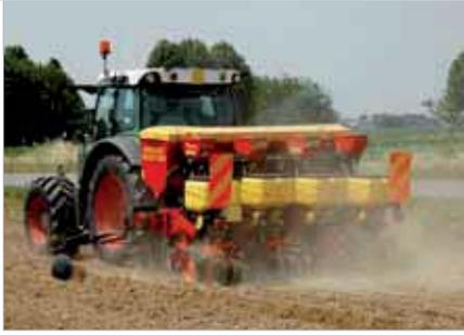
MS TWIN est l'élément de semis pneumatique de précision de la série MS 8000, avec rayonneur à double disque, qui permet de semer en double rang, avec la technique en quinconce. L'élément MS TWIN de MarterMacc permet de semer à une distance de 22 cm, entre les doubles rangs. La semeuse peut être configurée de 2 à 12 double rangs.
