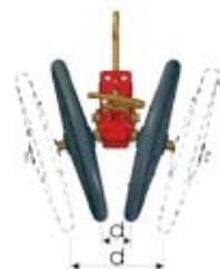
Réglage de l'angle de fermeture des roues.
