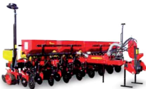
Semoir de précision en version semi-porté avec raccord en 3 points de II cat. Les éléments de semis sont montés directement sur le châssis rigide portant. Les deux roues de transmission sont également utilisées pour le transport sur route. Le semoir traîné permet d'utiliser des tracteurs avec de faibles puissances, la charge sur l'élevateur est uniquement 1/3 du poids total de la machine.
