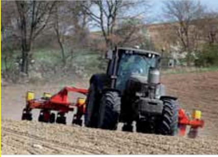
Semoir construite avec un châssis porteur central et deux châssis latéraux qui se replient hydrauliquement dans le sens vertical pour le transport.
