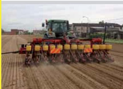
Semoir construite avec un châssis porteur central et deux châssis latéraux qui se replient hydrauliquement dans le sens vertical pour le transport.
