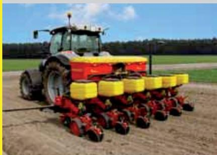
Il s'agit d'un semoir équipé d'un châssis télescopique hydraulique qui facilite la gestion de la machine pendant les déplacements sur route. La machine est très compacte et le poids en porte-à-faux est très réduit.
