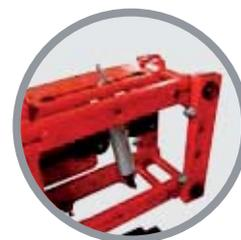
Ressort réglable pour augmenter la charge sur l'élément de semis.
