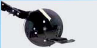
Élément à disques équipé de limiteur de profondeur.
