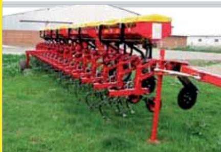
Bineuse avec triple châssis fixe, conçue pour les grandes exploitations agricoles. La caractéristique principale de ce modèle est la robustesse du châssis porte-éléments, nécessaire pour garantir le bon fonctionnement dans toutes les conditions, en prenant en compte plus de 12 mètres de largeur de travail.
