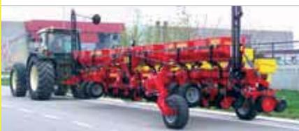
Le chariot permet une largeur de transport de 3,50 mètres et est amovible pour alléger le semoir au cours du travail.
