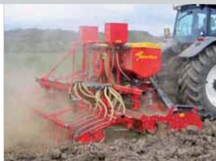
Semoir pneumatique en ligne pour le semis sur terrain travaillé ou semi-travaillé de céréales, des fourrages et du colza.
