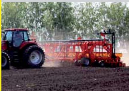
Semoir pneumatique de précision pour les grandes entreprises agricoles, pour ensemercer sur terrain ouvragé les cultures principales. Le châssis principal, équipé de roues d'appui grande section, présente deux systèmes de levage, oscillants, auxquels il faut accrocher les semoirs.
