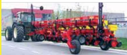
Le chariot permet une largeur de transport de 3,50 mètres et est amovible pour alléger le semoir au cours du travail.
