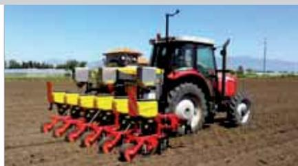
Le semoir de la série MS 4230 est un semoir très éclectique qui, grâce à la gestion hydraulique des éléments semeurs sur la barre Easy-Set (brevet MaterMacc) et de son châssis repliable, permet d'obtenir des largeurs de transport réduites même avec des semoirs ayant des largeurs de travail jusqu'à 6 mètres.
