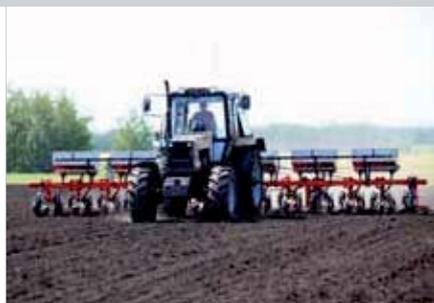
Bineuse avec double châssis fixe, conçue pour les grandes exploitations agricoles. La caractéristique principale de ce modèle est la robustesse du châssis porte-éléments, nécessaire pour garantir le bon fonctionnement dans toutes les conditions, en prenant en compte plus de 9 mètres de largeur de travail.
