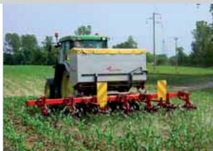
Bineuse avec châssis vertical repliable de façon hydraulique, destinée aux agriculteurs qui ont besoin de se déplacer souvent d'un champ à l'autre.
