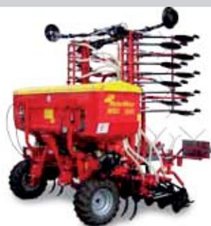
Semoir pneumatique en ligne pour le semis sur terrain travaillé ou semi-travaillé. Dans la version MSD, pour les largeurs de travail supérieures à 3 mètres, les châssis se replient par un système hydraulique pour obtenir une largeur de transport égale à 2,55 mètres.
