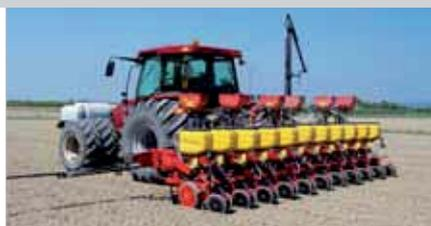
Le semoir de la série MS 8230 est un semoir très éclectique qui, grâce à la gestion hydraulique des éléments semeurs sur la barre Easy-Set (brevet MaterMacc) et de son châssis repliable, permet d'obtenir des largeurs de transport réduites même avec des semoirs ayant des largeurs de travail jusqu'à 6 mètres.
