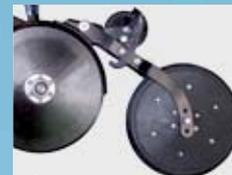
Élément à double disques équipé avec roulette plombeuse.
