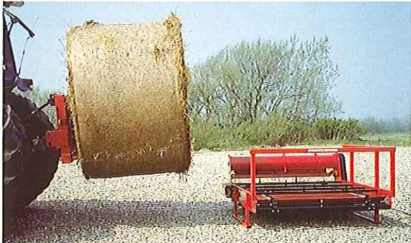
Um die Befüllung zu erleichtern, ist RONDO-DAN mit ausziehbaren Ladezinken versehen. Diese Konstruktion ermöglicht das selbständige Aufnehmen eines Ballens.
