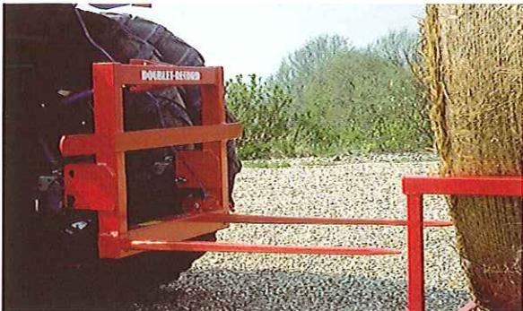
Schnell sind die Ladezinken wieder ins Grundgerät eingerückt und der hydraulische Antrieb wird automatisch angekuppelt.
