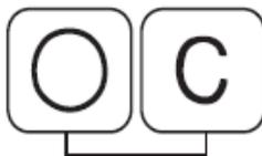
Durch gleichzeitiges Drücken der Tasten "0" und "C" werden alle Speicher gelöscht, einschließlich der Impulszahl/100m sowie des Fahrgassenrhythmus.
