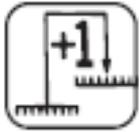
Mit dieser Taste kann die aktuelle Stellung innerhalb des gewählten Fahrgassenrhythmus um einen Schritt weiterschaltet werden.
