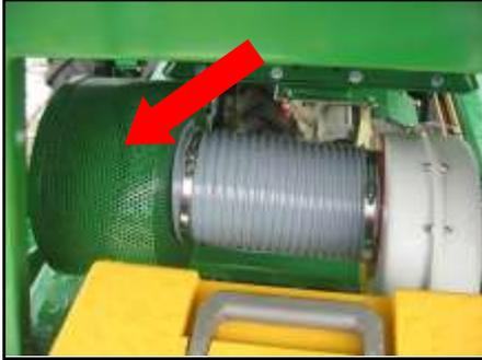
Der Ansaugschutz vom Gebläse muss immer frei von Ernterückständen (Stroh, Erde) sein, um ein ungehindertes Ansaugen des Gebläses zu gewährleisten. Die Gebläsedrehzahl muss mit Hilfe des Stromregelventils des Traktors auf die erforderliche Drehzahl eingestellt werden. Alternativ dazu kann diese Einstellung auch am Stromregelventil der Sämaschine vorgenommen werden.
