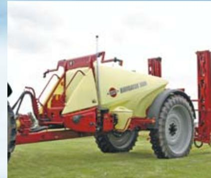
La suspension trapèze, réglable pour obtenir le comportement optimal, assure une excellente stabilité quelles que soient les conditions du terrain et la vitesse d'avancement. Un dispositif anti-fouettement intégré à la section centrale minimise les mouvements horizontaux de la rampe.
