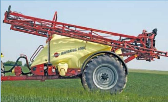
La suspension pendulaire, équipée d'un ressort largement dimensionné et d'un amortisseur, absorbe les mouvements verticaux et latéraux. Le blocage hydraulique stabilise la rampe pendant les opérations de dépliage/repliage.
