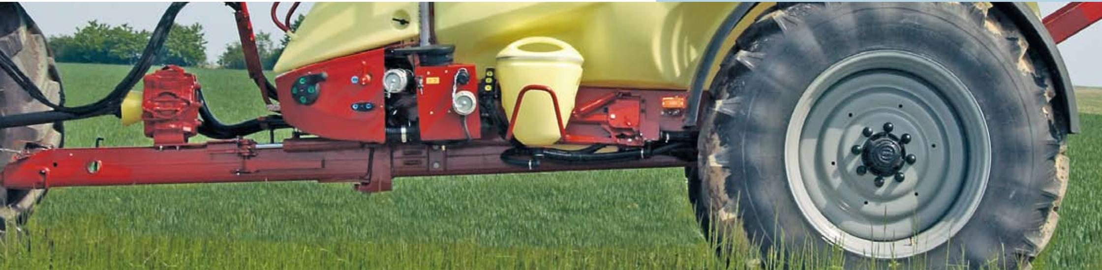
Le châssis et les essieux du NAVIGATOR sont conçus pour rouler à des vitesses élevées dans les conditions de terrain et de route les plus exigeantes. Le châssis robuste est fabriqué en acier HLE (haute limite d'élasticité).
