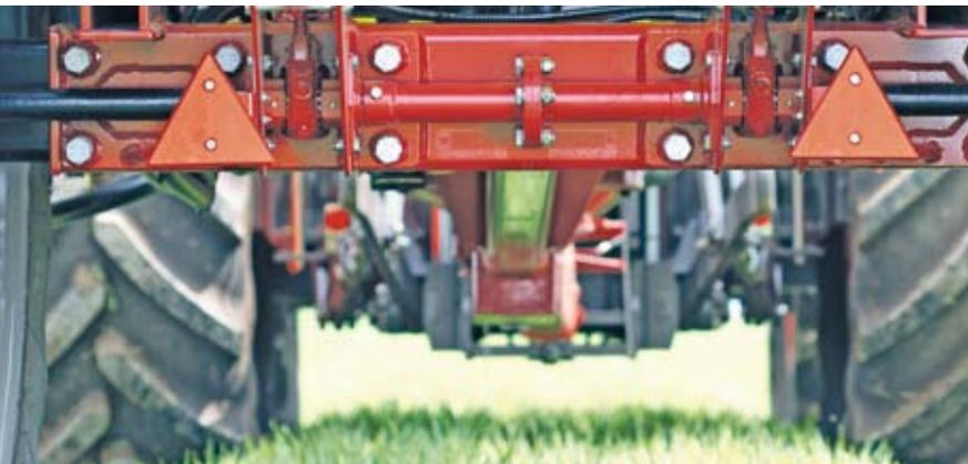
La conception unique du châssis et des essieux assure un excellent dégagement au dessus des cultures, réduisant tout dommage au minimum absolu. Aucun composant, que ce soit des freins ou de la flèche suiveuse, ne se trouve plus bas que les essieux.
