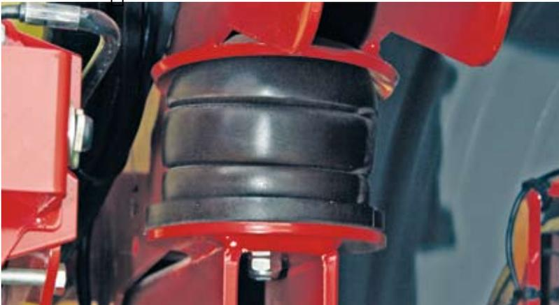
La suspension de châssis, en option, est un système simple et fiable qui ne nécessite que peu d'entretien. Elle autorise des vitesses de travail plus élevées avec une meilleure stabilité de rampe et améliore le confort, la performance et la productivité.
