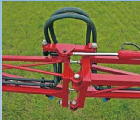
Un dispositif mécanique verrouille les sections de la rampe pour un parfait alignement.
