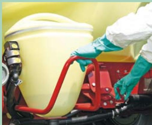
Il est monté sur un support, avec ressort de rappel et verrouillage automatique en position transport, rendant sa hauteur de chargement de 95 cm particulièrement confortable.
