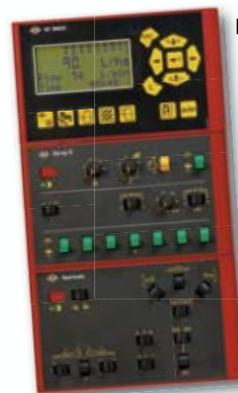
Le HC 5500 contrôle en permanence la vitesse d'avancement suivant la largeur de voie afin de vérifier que la fonction suiveur n'est utilisée qu'en toute sécurité. Par exemple si l'opérateur effectue un virage à 90° à 15 km/h, l'équipement IntelliTrack, qui enregistre automatiquement les données, interdira le suivi des traces.
