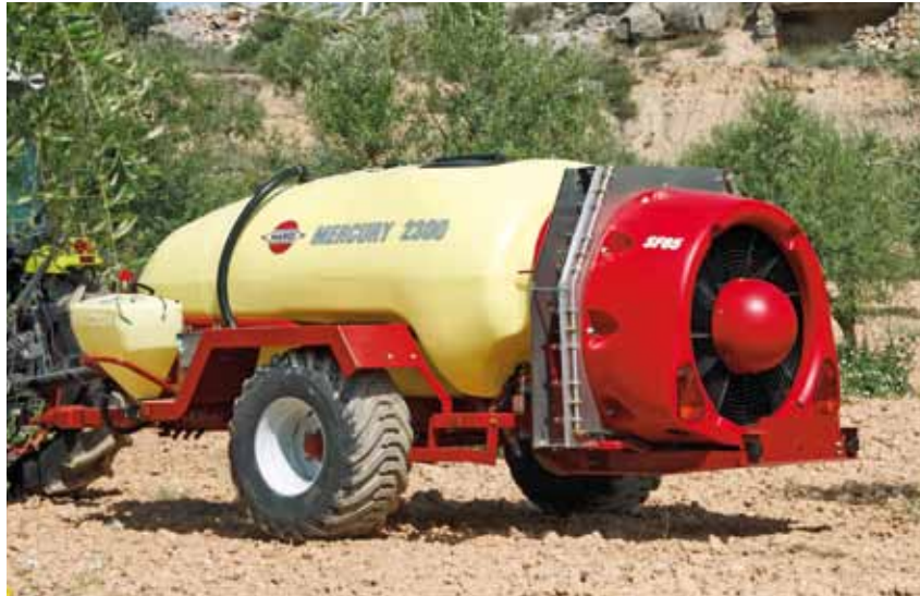
MERCURY avec déflecteur Olives, garde-boue et incorporeur de produits.
