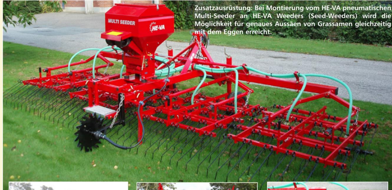
Zusatzrüstung: Bei Montierung vom HE-VA pneumatischen Multi-Seeder an HE-VA Weeders (Seed-Weeders) wird die Möglichkeit für genaues Aussäen von Grassamen gleichzeitig mit dem Eggen erreicht.
