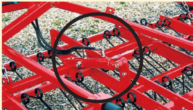
Alle HE-VA Weeder sind mit 1,50 m pendeln aufgehängten Striegelsektionen konstruiert, was eine optimale Boden Anpassung gewährleistet. Die 5 Zinkenträger sind mit Doppelzinken montiert, die schnell und werkzeuglos gewechselt werden können, z.B. bei Reihenkulturen. Der Anstellwinkel der Zinke ist an jeder Eggensektion mit einem Handgriff leicht verstellbar.
