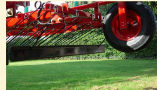
Zusatzrüstung: Eineinhebungsschiene, sehr effektiv für Ebenen von Maulwurfhügeln
