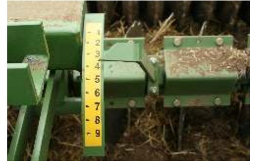
Réglage de la profondeur de travail par vérin hydraulique avec réglette de repère
