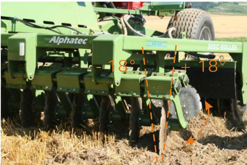
La combinaison des disques et du rouleau permettent d'obtenir un mélange, une incorporation idéale des résidus et un ré-appuis du sol d'environ 1 tonne mètre. Le travail est réalisé par deux rangées de disques inclinés et crénelés montés sur palier à doubles roulement à billes à contact oblique.
