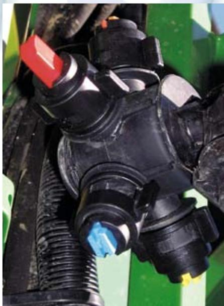
Pour les porte-buses TeeJet ou similaire, utilisez les buses simples (S) et l'écrou noir 334862 qui convient également pour les buses INJET et MINIDRIIFT, (joint : 242222).
