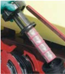
**2** Le filtre autonettoyant ou le filtre Cyclone. Un système by-pass garantit la propreté du tamis. De série le maillage est 80 mesh.
