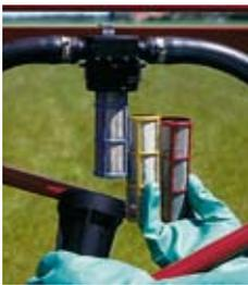
**3** Les filtres de rampe réduisent le colmatage des filtres de buses et facilitent le nettoyage des tamis.
