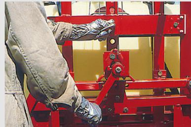
Relevage de rampe mécanique
