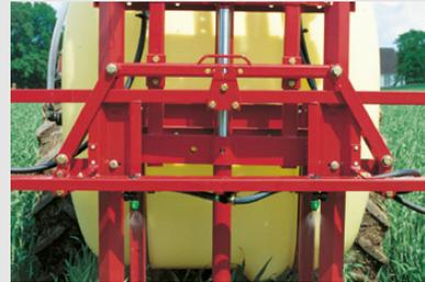
Relevage de rampe hydraulique
