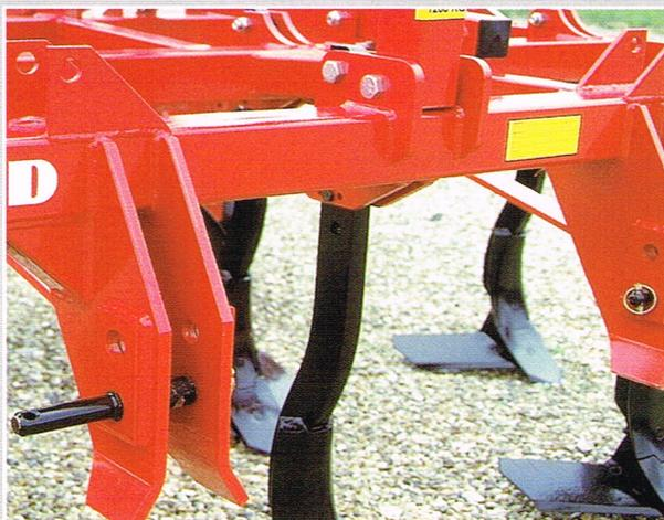
Un système d'attelage en chape permet à l'aide de broches réversibles d'adapter le Mega-Dan aussi bien aux tracteurs équipés de relevage catégorie II ou III.
