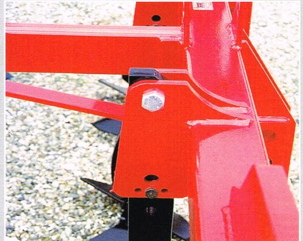
Les dents rigides sont dotées de sécurité par boulons de rupture. Trois angles d'attaque différents permettent d'adapter la dent à n'importe quel type de sol.
