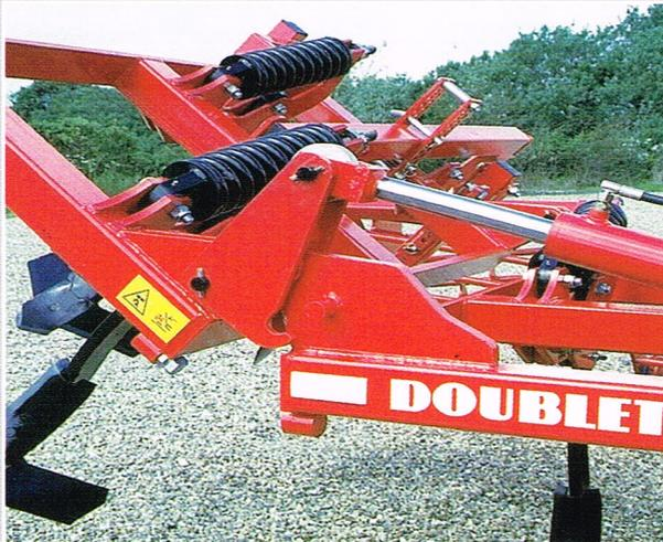
Le système d'ouverture hydraulique est assuré par de puissants vérins double effets. Après dépliage des sections latérales, elles sont verrouillées automatiquement afin d'éviter, sur les surfaces irrégulières, tout repliage intempestif.
