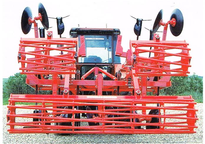
Le châssis de base 3,00 m (7 dents) peut être élargi à l'aide de rallonges jusqu'à 4,70 m (11 dents).
