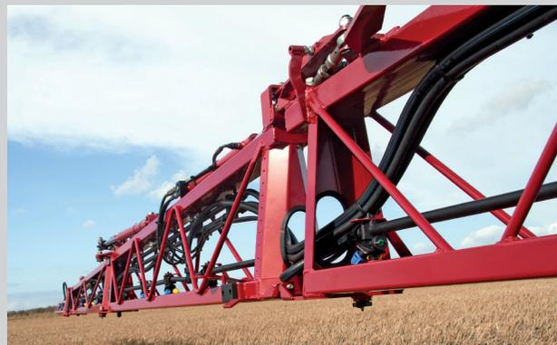
La construction de la rampe en treillis assure robustesse et rigidité garantissant une distribution précise et uniforme. Les buses, canalisations et tuyaux sont parfaitement protégés dans la structure de la rampe.
