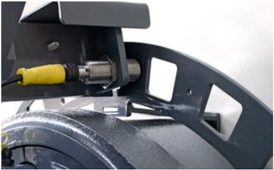
Le capteur de vitesse est fixé face à un disque 24 trous pour plus de précision. Ce disque est solidaire du moyeu pour faciliter les changements de pneumatiques. L'info vitesse peut également être donnée par l'antenne GPS si présente.
