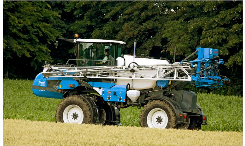
L'ALPHA evo VariTrack est également disponible en « version coteaux 25 km/h » ou « version coteau 30 km/h » avec freins intégrés pour les régions à fort dévers ou la topographie du terrain est accidentée et difficile.
