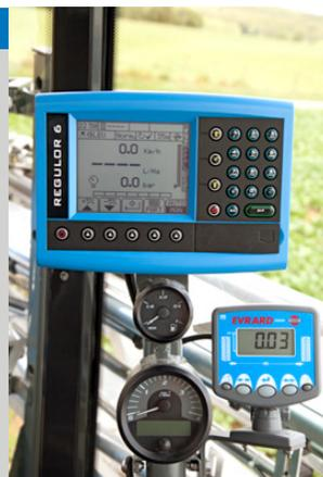
L'option « voie variable hydraulique » permet de contrôler en continu la voie de l'automoteur à l'aide d'une commande électrique en cabine.
