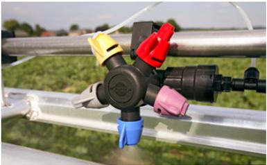
Les pentabuses pneumatiques assurent une ouverture et fermeture ultra-rapides en ayant toujours la garantie de rampes parfaitement chargées en produit.
