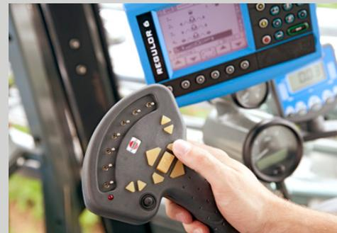
Le REGULATOR 6 de série, basé sur une architecture BUS CAN, ainsi que l'avènement de nouvelles options telles que la technologie d'application OPTI-SPRAY, ou la console CFX 750 permettant la combinaison « Guidage + gestion des tronçons par GPS » illustrent parfaitement le haut degré d'équipement et de confort proposé sur cette nouvelle génération d'automoteurs.
