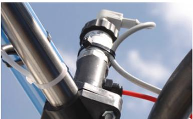
Le capteur de pression (information ou régulation) permet l'affichage de la pression sur l'écran du REGULOR 6 ou assure la régulation de la pulvérisation.
