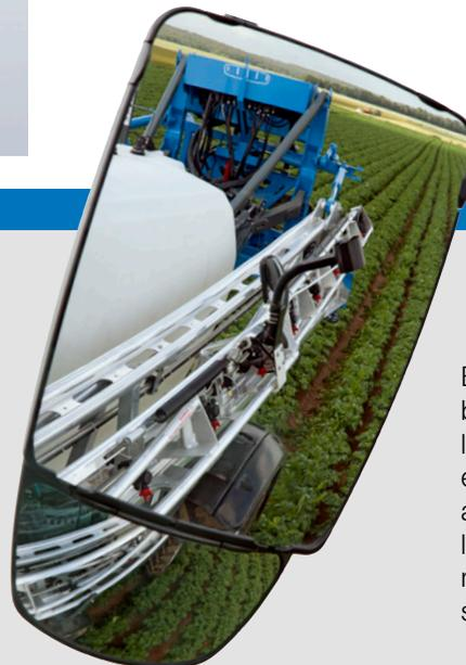
En position transport, les bras de rampe sont à l'horizontal offrant ainsi un excellent champ de vision au conducteur et le parallélogramme est automatiquement verrouillé pour plus de sécurité et de longévité.
