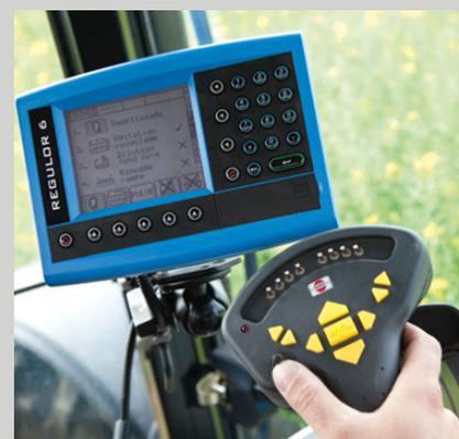
HARDI-EVRARD propose un dispositif de dilution du fond de cuve qui apporte confort et efficacité lors des rinçages. L'opérateur n'a plus besoin de descendre de la cabine pour manipuler les vannes de mise en oeuvre car le dispositif est directement commandé depuis les menus du boîtier REGULOR 6. Dans ce cas, la vanne d'agitation est également à commande électrique.
