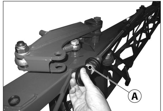
10. Nach der Einstellung durch die Bohrung hindurchschauen: Dies sollte wie dargestellt aussehen. Der Zylinder ist dabei vollständig ausgefahren.
